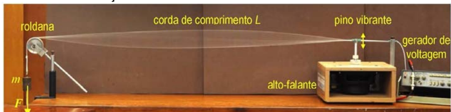
Figura 4.3 - Dispositivo para a geração de ondas estacionárias em uma corda com os extremos presos. Na imagem é mostrada a excitação do modo fundamental n=1 .
