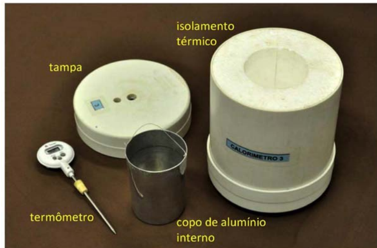
Figura 5.1 - Calorímetro utilizado nos experimentos (desmontado)
