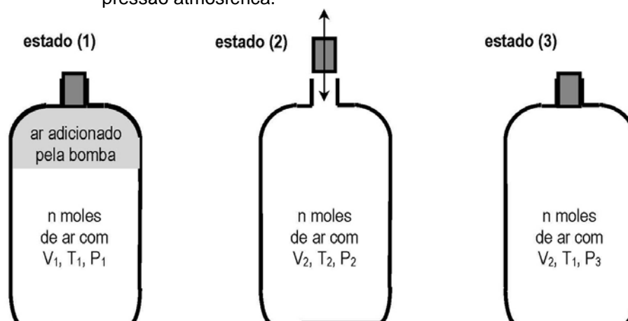
Figura 6.4 - Representação esquemática dos três estados considerados no processo do experimento de Cléments-Desormes. P_2 = pressão atmosférica.
